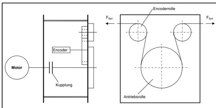
Mitnahme des Seils wird durch Umschlingung realisiert
