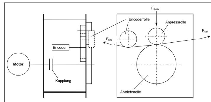
Mitnahme des Seils wird durch zusätzliche Anpressrolle realisiert
