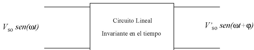
**Fig. 0.45 : Respuesta de un sistema lineal e invariante en el tiempo a una señal senoidal.**
