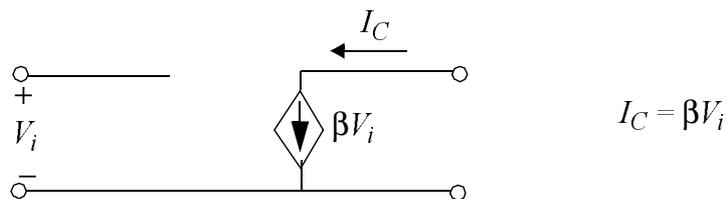
**Fig. 0.24 : Fuente de intensidad controlada por tensión.**
