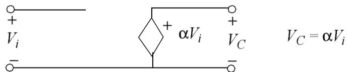
**Fig. 0.23 : Fuente de tensión controlada por tensión.**
