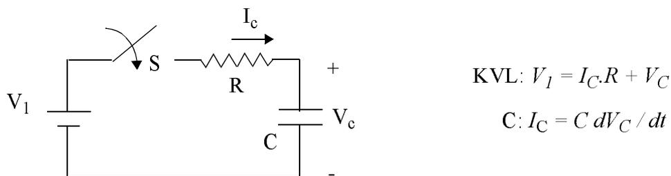
**Fig. 0.39 : Circuito RC sometido a una evolución en el tiempo.**
