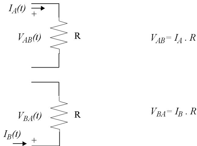
**Fig. 0.18 : Resistencia como elemento bilateral.**
