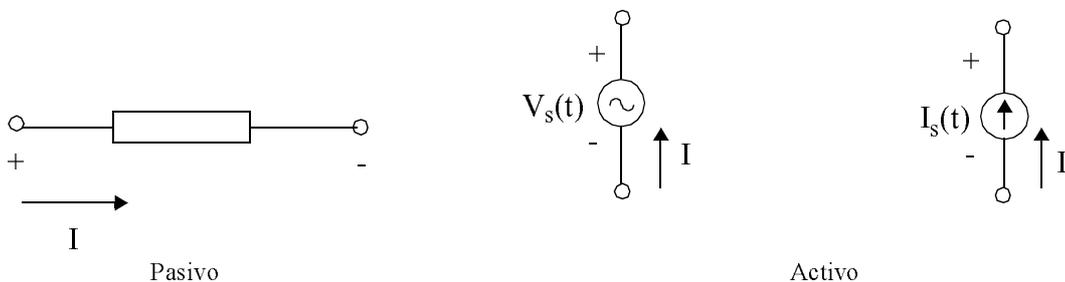
**Fig. 0.31 : Sentido de la intensidad para elementos pasivos y activos.**
