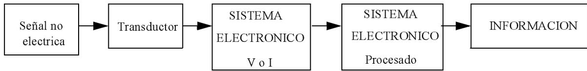
**Fig. 0.3 Bloques de un sistema de comunicaciones necesarios para el procesado de la información**
