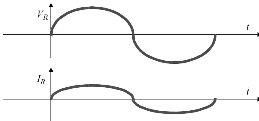
**Fig. 0.42 : Relación tensión-intensidad para una resistencia alimentada por una señal senoidal de tensión.**
