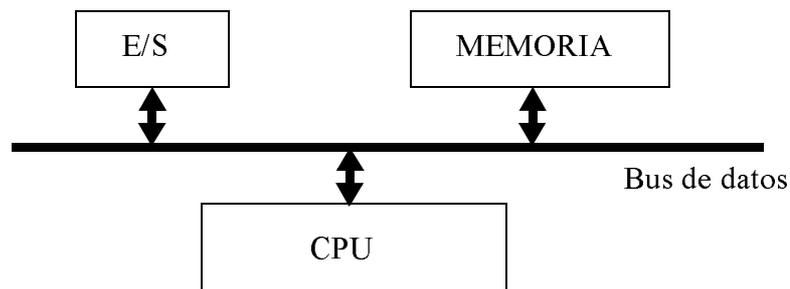
**Fig. 0.2 Componentes de un computador.**
