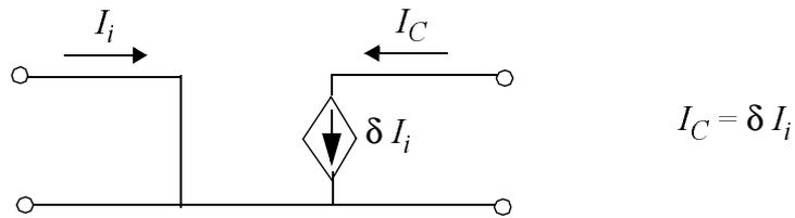
**Fig. 0.25 : Fuente de intensidad controlada por intensidad.**
