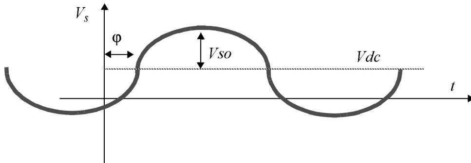
**Fig. 0.41 : Forma de onda de una señal senoidal.**
