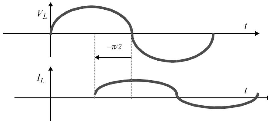
**Fig. 0.44 : Relación tensión-intensidad para una bobina alimentada por una señal senoidal de tensión.**
