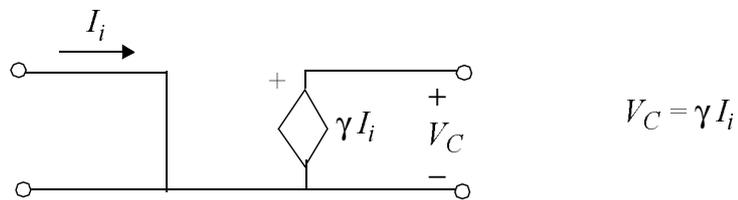
**Fig. 0.26 : Fuente de tensión controlada por intensidad.**
