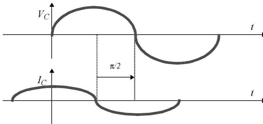
**Fig. 0.43 : Relación tensión-intensidad para un condensador alimentada por una señal senoidal de tensión.**
